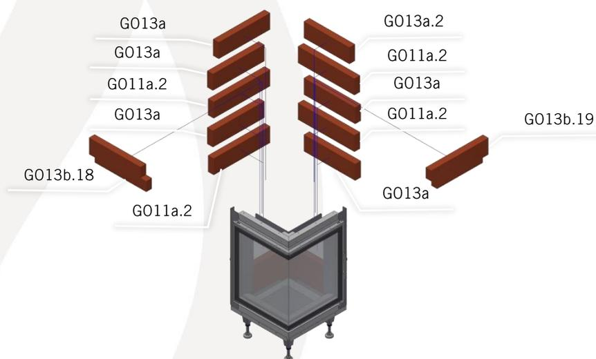
Bevor Sie mit den Mantelsteinen über die Tür mauern, ist diese mittels den seitlichen Klemmleisten winkelig zur Bodenplatte auszurichten und festzuschrauben.
