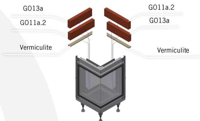
Legen Sie zunächst die Vermiculitestreifen auf die Fasermatten und dann die 1. Reihe der Mantelteile trocken ins Grundgestell. Die erste Reihe wird nur an den Stirnseiten zueinander mit Versetzmörtel HK verklebt.
