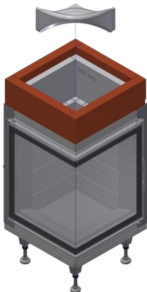
Positionieren Sie die Umlenkplatte auf den GOS, und schieben Sie diese immer ganz nach hinten und zur Seite des Ausbrandes.
