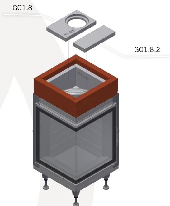
Positionieren Sie nun die Abdeckung der Nachbrennkammer.
